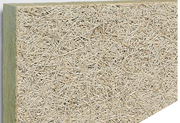
Die Fibro THERM-S 2 N – 035 A2 ist eine Mehrschichtplatte aus einer mineralisch gebundenen Holzwollschicht mit Steinwollekern für die thermische Dämmung mit schallschluckender Wirkung und effektiven Brandschutz. Für die Herstellung wird neben Weißzement und Steinwolle nur Fichtenholz aus PEFC- bzw. FSC®-zertifizierter Waldwirtschaft verwendet, wodurch eine nachhaltige Lieferkette des natürlichen Rohstoffes Holz garantiert wird.
