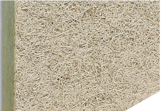
Die Fibro THERM-S 2 N – 035 B1 ist eine Mehrschichtplatte aus mineralisch gebundener Holzwollschicht mit Steinwollekern für die thermische Dämmung mit schallschluckender Wirkung und effektiven Brandschutz. Für die Herstellung wird neben Weißzement und Steinwolle nur Fichtenholz aus PEFC- bzw. FSC®-zertifizierter Waldwirtschaft verwendet, wodurch eine nachhaltige Lieferkette des natürlichen Rohstoffes Holz garantiert wird.
