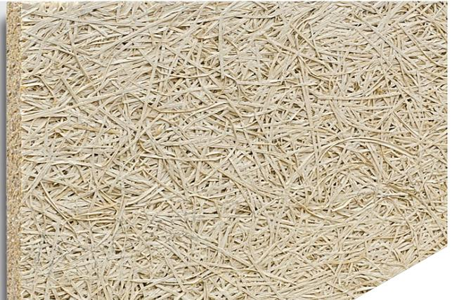
Die Fibro Stall-Lüftungsplatte ist eine mineralisch gebundene Holzwoleplatte zur Verbesserung der Luftzirkulation und Raumakustik in Agrarbauten mit einer Faserbreite von 2 mm in der Brandschutzklasse B-s1, d0. Für die Herstellung wird neben Weißzement nur Fichtenholz aus PEFC- bzw. FSC<sup>®</sup>-zertifizierter Waldwirtschaft verwendet, wodurch eine nachhaltige Lieferkette des natürlichen Rohstoffes Holz garantiert wird.
