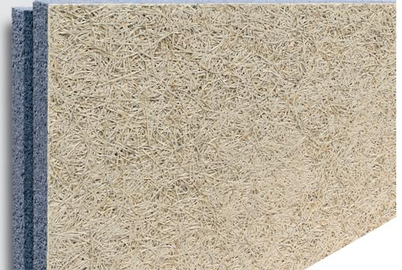
Die Fibro DUR 3 A – 032 SE ist eine Mehrschichtplatte aus einer mineralisch gebundenen Holzwolledeckschicht mit Polystyrolkern für die thermische Dämmung von Decken und Wänden mit Stufenfalz rundum. Für die Herstellung wird, neben Weißzement und Polystyrol aus recyceltem Material, nur Fichtenholz aus PEFC- bzw. FSC®-zertifizierter Waldwirtschaft verwendet, wodurch eine nachhaltige Lieferkette des natürlichen Rohstoffes Holz garantiert wird.
