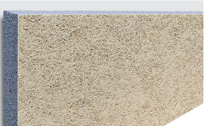
Die Fibro DUR 2 N – 032 SE ist eine Mehrschichtplatte aus einer mineralisch gebundenen Holzwolledeckschicht mit Polystyrolkern für die thermische Dämmung von Decken und Wänden. Für die Herstellung wird, neben Weißzement und Polystyrol, nur Fichtenholz aus PEFC- bzw. FSC®-zertifizierter Waldwirtschaft verwendet, wodurch eine nachhaltige Lieferkette des natürlichen Rohstoffes Holz garantiert wird.
