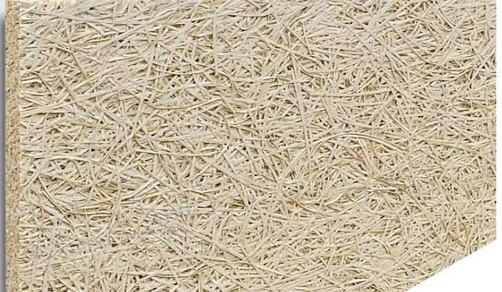
Die Fibro Kustik Protect ist eine mineralisch gebundene Holzwoleplatte mit rückprallhemmender Wirkung und Faserbreite von 1 mm in der Brandschutzklasse B s1, d0. Für die Herstellung wird neben Weißzement nur Fichtenholz aus PEFC- bzw. FSC®-zertifizierter Waldwirtschaft verwendet, wodurch eine nachhaltige Lieferkette des natürlichen Rohstoffes Holz garantiert wird.
