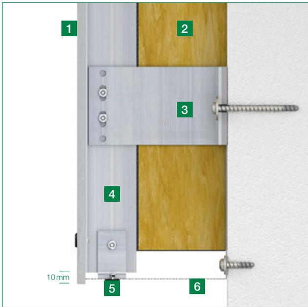
Es muss sichergestellt werden, dass die Fassadentafel die Unterkonstruktion 10mm überdeckt, damit das Wasser von der Fassade abtropfen kann. Bitte bringen Sie ein Lüftungsprofil ein um sicherzustellen,
