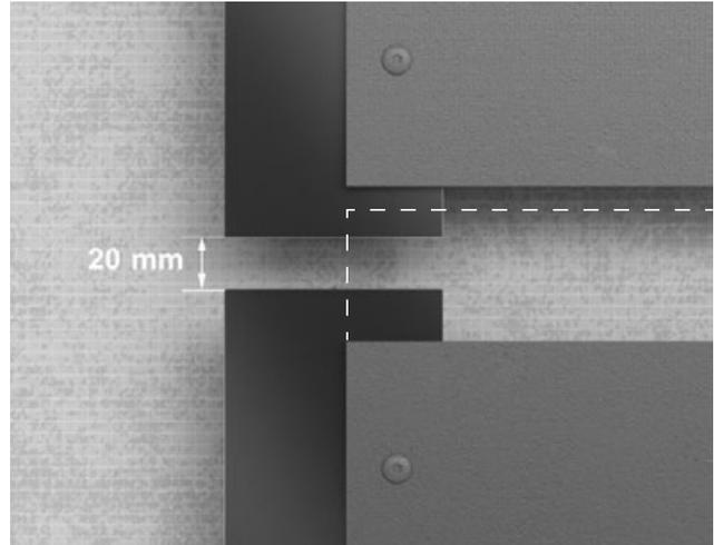
Das T-Profil hinter den Fugen muss mindestens 100 mm breit, das L-Profil im Plattenfeld mindestens 40 mm breit sein. Es darf eine maximale Fugenbreite von 10 mm ausgeführt werden. Die optimale Fugenbreite liegt bei 8 mm.
