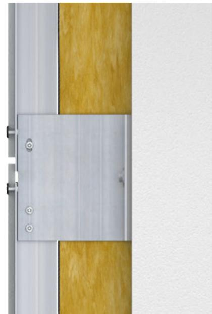
Profilstoß verdeckt mit Kombinationsverbindung an einem Wandhalter
