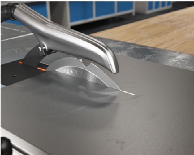
Vorschub und Schnittgeschwindigkeit sollten je nach verwendeten Sägen und Sägeblättern optimiert werden. Generell ermöglichen höhere Schnittgeschwindigkeiten eine bessere Schnittkantenqualität.
