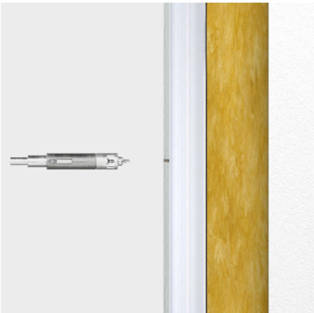
Abschließend wird der Fassadenniet mit Hilfe eines Nietsetzgerätes gesetzt. Es empfiehlt sich die Festpunkte der Fassadentafel als erstes zu setzen, damit diese an der Unterkonstruktion fixiert sind. Dabei wird die Festpunkthülse in die Plattenbohrung eingesetzt. Der Nietkopf muss plan auf der Oberfläche der Fassadentafel aufliegen.
