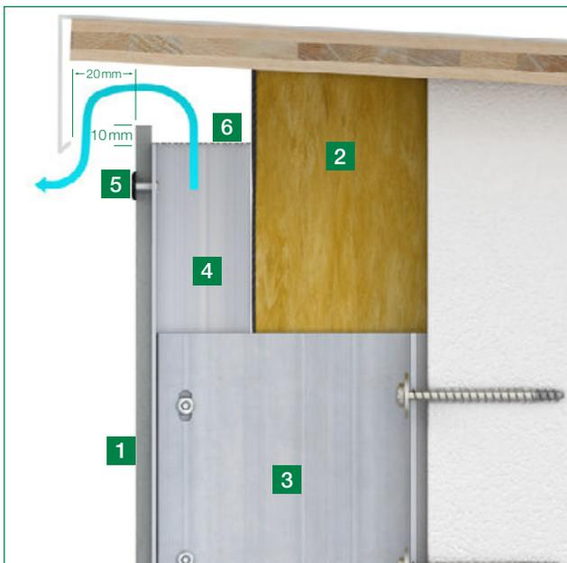
Es muss sichergestellt werden, dass die Luft hinter der Fassadentafel frei strömen kann. Die Fassadentafel muss mindestens 10mm über die Unterkonstruktion hinweg ragen. Es muss ein Lüftungsquerschnitt von min. 50 cm<sup>2</sup> pro laufenden Meter verwendet werden, um die Hinterlüftung zu gewährleisten. Von der oberen Kante der Fassadentafel bis
