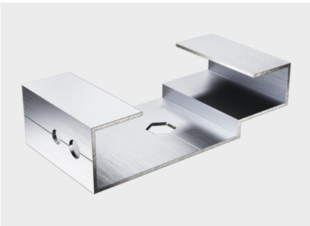
Agraffe Typ C Agraffe mit werkseitig versehener Bohrung, üblicherweise mit Innengewinde, für die Feinjustierung der Fassadenplatte und zusätzlicher Bohrung zum Setzen einer Feststellschraube. Mit dem Setzen der Feststellschraube wird ein Festpunkt erzeugt. Alternativ können zur Feststellschraube auch seitlich montierte Sicherungswinkel verwendet werden.
