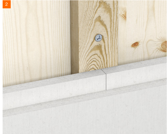
2 Holz-Unterkonstruktion vertikal oder horizontal
