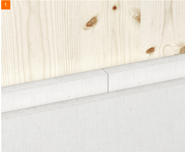
1 Direkt Beplankung auf Massivholz/Brettsper Holz (alternativ Holzwerkstoffplatten)
