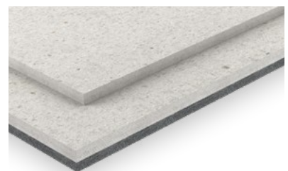
fermacell® Estrichelement mit Filzfaserdämmung in 9 mm Dicke
