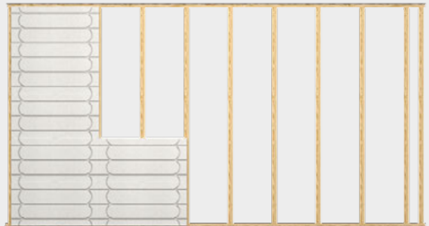
Montage der Therm25™ Elemente in Unterkonstruktion (Schrauben 40 mm oder Klammern 50 mm)
