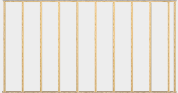
Achsabstand Unterkonstruktion max. 500 mm
