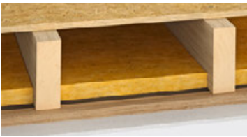
Geschlossene Holzbalkendecke, Unterdecke auf Lattung
