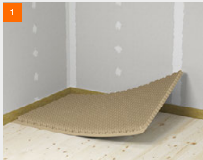
fermacell™ Estrichwabe verlegen
