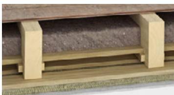
Geschlossene Holzbalkendecke, Einschub nicht tragend
