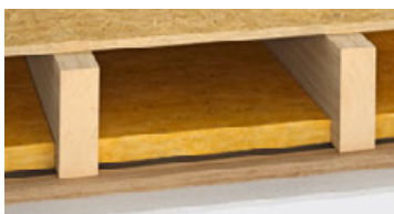
Geschlossene Holzbalkendecke, Unterdecke auf Lattung
