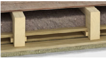
Geschlossene Holzbalkendecke, Einschub nicht tragend
