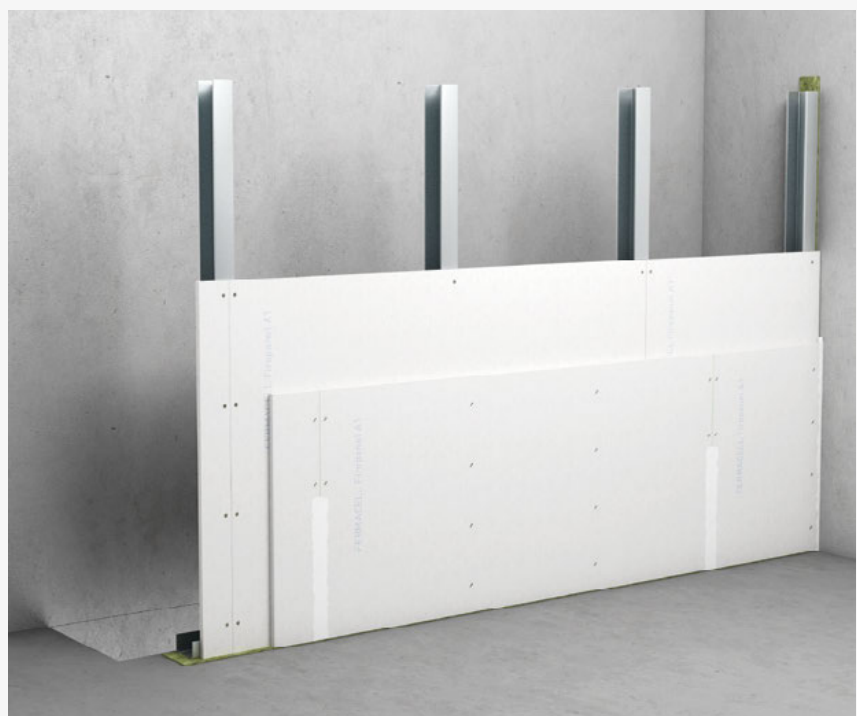
Konstruktion mit fermacell® Firepanel A1
