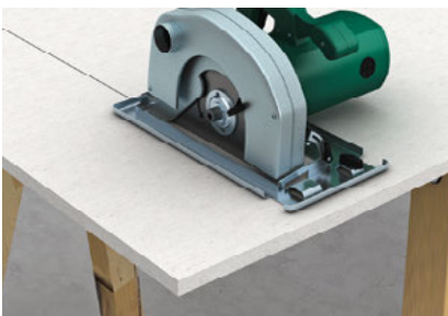
Sägen mit Handkreissäge (Drehzahl regulierbar)
