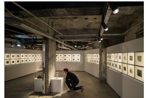
Die Wirkung der streng linearen Bildanordnung lässt sich hervorragend durch Konturenstrahler verstärken, die die Lichtkegel auf die Bildfläche begrenzen und die übrige Wand unbeleuchtet lassen.
