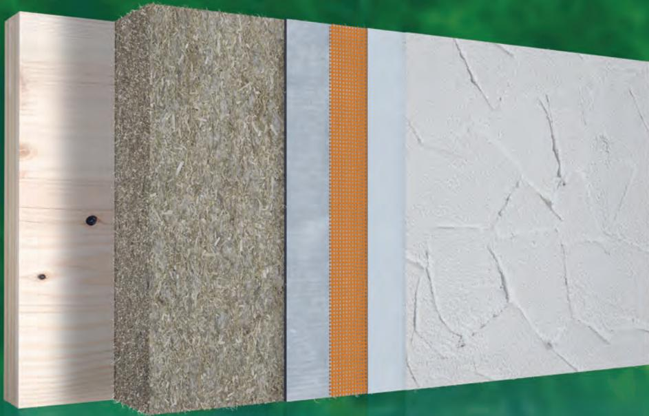
**Schallschutzprüfung** Bei den gemeinsam mit dem steirischen Unternehmen KLH durchgeführten Schallschutzprüfungen wurde mit 20 cm Hanfdämmung auf 9,4 cm Kreuzlagenholz ein Schallschutz von 54dB erreicht. Damit liegt diese Konstruktion deutlich über der Schallschutzanforderung  $R_w$  von 43dB für opake Außenbauteile.
