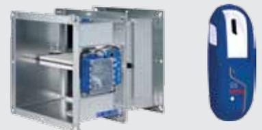
**TROX Entrauchungsklappen EK-EU**, CE-zertifiziert, gem. BauPVO, sind in der Lage, nach 25 Min. bei erhöhten Temperaturen (ca. 800 °C) von der geschlossenen in die geöffnete Stellung und umgekehrt zu fahren (MA – manuelle Auslösung).
