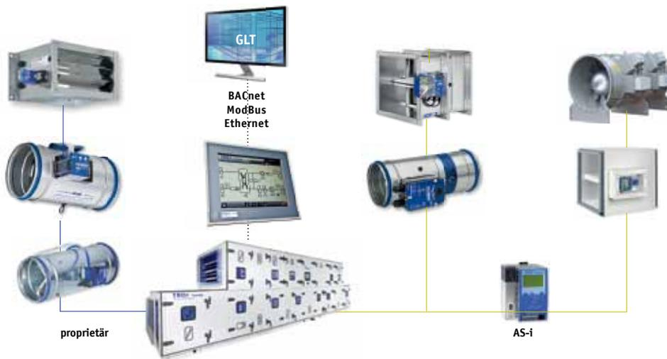
*Das X-CUBE RLT-Gerät mit zentraler Automationsebene übernimmt innerhalb des Gewerks Klima und Lüftung die Steuerung und das Monitoring seiner Komponenten wie dem Volumenstromregelgerät, zum Beispiel via Modbus, Brandschutz-, Entrauchungskappen und Prozessabluftventilatoren über das praxisbewährte AS-i-System.*
