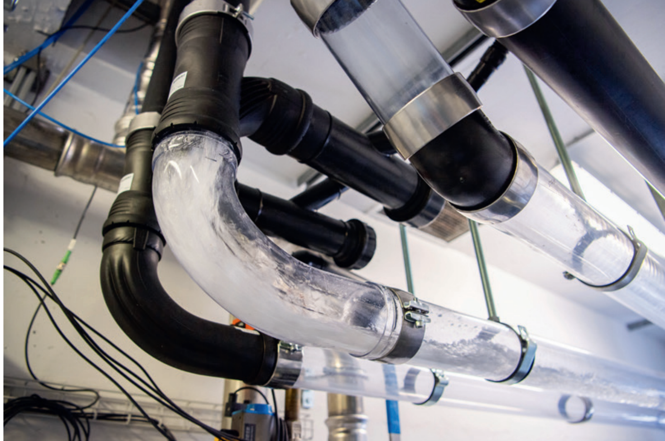
Der Test mit transparenten Teilen ermöglicht Einblicke in das tatsächliche Strömungsverhalten der neuen Formstücke
