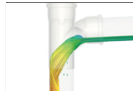
Mit der numerischen Strömungssimulation CFD (Computational Fluid Dynamics) können Varianten vorab virtuell getestet werden...
