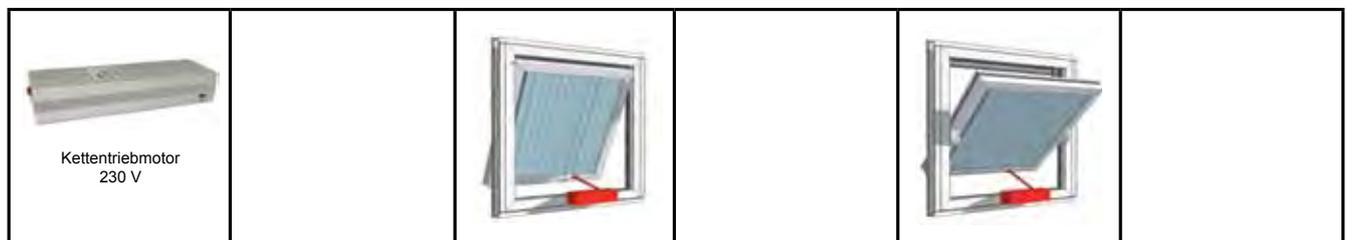
Kettentriebmotor mit einstellbarem Hub zwischen 90 - 400 mm. Anschlussspannung der Motoren 230 V. Leistungsaufnahme 150 W, Stromaufnahme 0,8 Aac. Schutzart IP 20.
