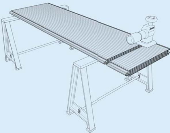
Wenn die Paneele nicht auf Maß geliefert wurden, muss die Bemessung der Paneellängen gemäß des tech. Handbuches erfolgen. Das Zuschneiden der Paneele ist wie unter Punkt 12 beschrieben durchzuführen.
