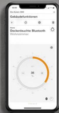
Das Gira System 3000 bietet den einfachen Einstieg in die Gebäudeautomation für Licht- und Jalousiesteuerung sowie Raumtemperaturregelung. Der Automatisierungsgrad kann auf Raumebene oder im ganzen Gebäude jederzeit ohne Neuverkabelung angepasst werden.
