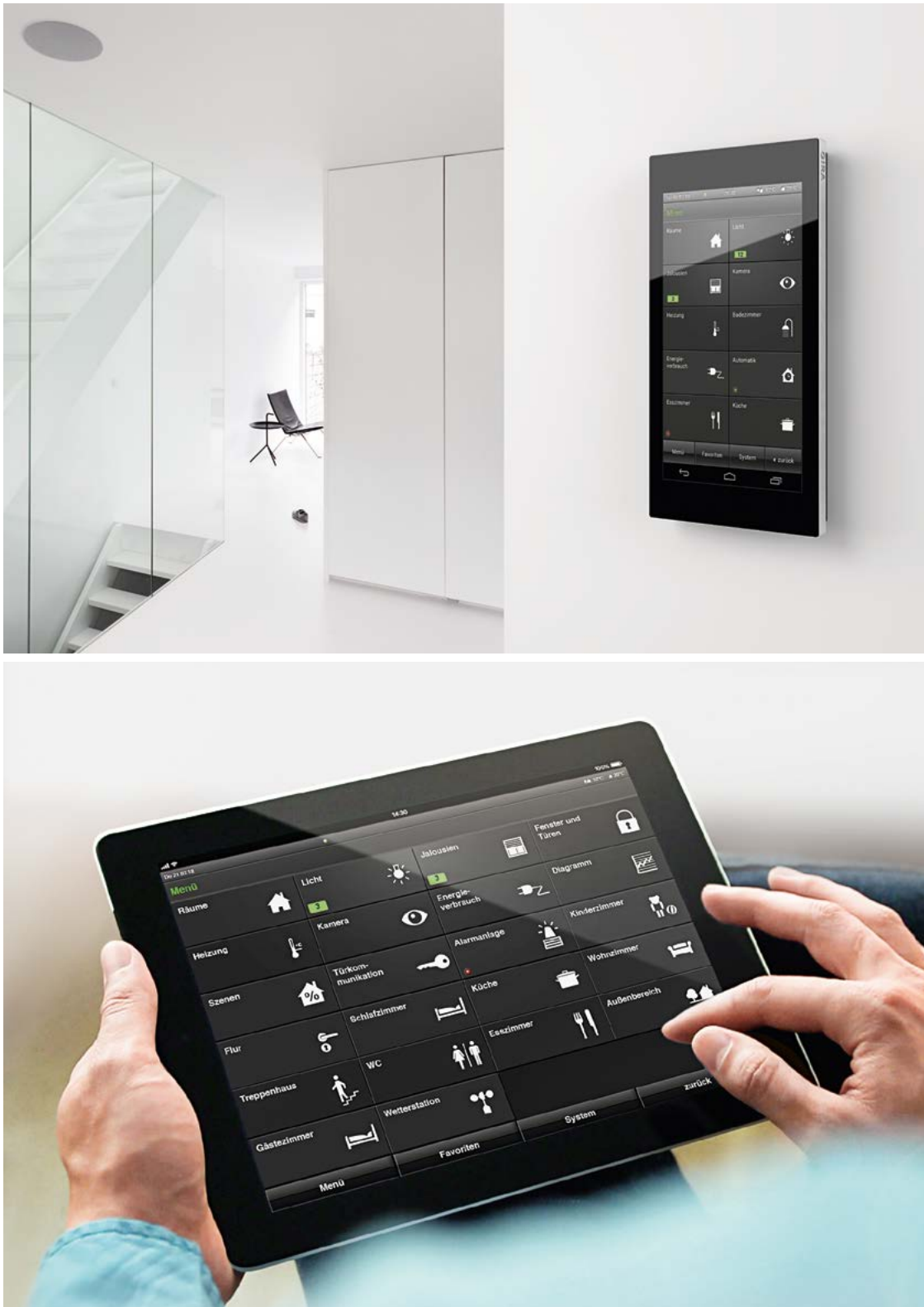
Abb. oben: Verknüpft und gesteuert wird das Smart Home vom Gira HomeServer. Intuitiv bedienen lässt es sich z. B. über den Gira G1, der an zentraler Stelle im Haus an der Wand hängt.
