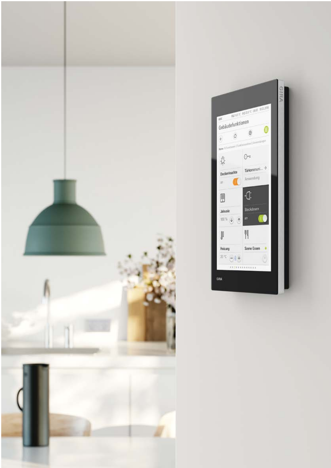
Abb.: Zahlreiche Funktionen lassen sich auf dem Gira G1 als Kacheln anzeigen. Zentrale Funktionen wie Ein- und Ausschalten oder Einstellen der Raumtemperatur können schon in dieser Ansicht bedient werden. Darüber hinaus ist es möglich, einzelne Funktionen in einem Funktionsordner zu bündeln, beispielsweise für alle Funktionen eines Raums.
