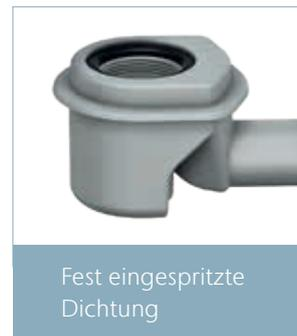
▲ Bei der Installation ist eine dauerhaft dichte Verbindung der Komponenten sehr wichtig: Alle Ablaufkörper der ACO ShowerDrain M+ sind mit einer fest eingespritzten Dichtung ausgestattet. Somit ist ausgeschlossen, dass die Dichtung aus Versehen verloren geht oder diese bei der Montage verrutscht.
