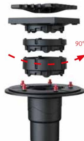
Durch eine Drehung des Aufsatzrahmens mit Rost um jeweils 90° kann der Aufsatzrahmen somit zusätzlich um jeweils 5mm Stufen angehoben werden. Diese Höhenverstellung in 5 mm Schritten kann auch durch zwei aufeinander folgende Höhenverstellringe durchgeführt werden.
