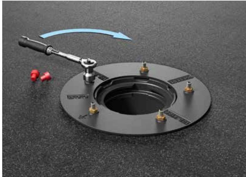
Der Ablauf und der Losflansch dürfen mit einem maximalen Drehmoment von 20 Nm belastet werden. Spezifisches Drehmoment der verwendeten Abdichtung ist mit dem Hersteller zu klären.
