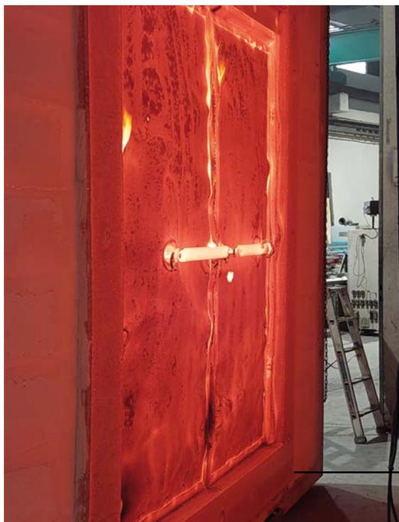
**MABA FERTIGTEILINDUSTRIE LÄSST NICHTS ANBRENNEN:** Die neuen HPFC-Tunnelsicherheitstüren wurden im Brandversuch für eine Feuerwiderstandsklassifizierung von EI<sub>2</sub>120 klassifiziert: Das bedeutet, dass der Raumabschluss (E) sowie die Wärmedämmung (I) auf eine Dauer von 120 Minuten bei 1.050 Grad Celsius immer noch voll erfüllt sind.
