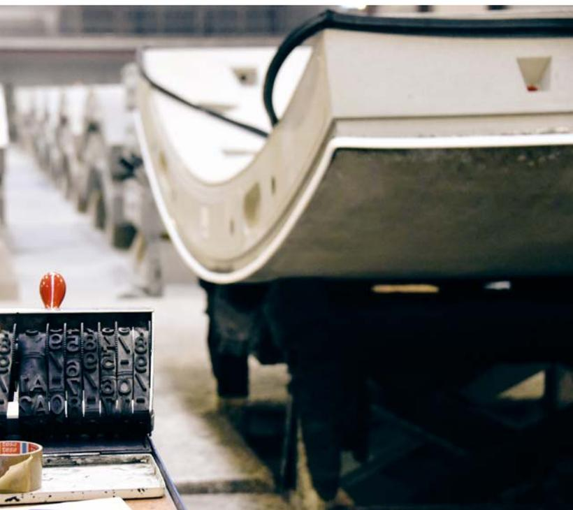
Insgesamt wurden in der Feldfabrik in St. Andrä über 42.000 Tübbinge für den ca. 10,5 km langen Bauabschnitt hergestellt. Dabei mussten zu jeder Zeit ca. 2.000 Tübbinge mit unterschiedlichen Spezifikationen am Lagerplatz bereit liegen, die von dort bis vor Kurzem noch für den Einbau herangezogen wurden – lange, nachdem die Produktionshalle bereits abgebaut wurde.
