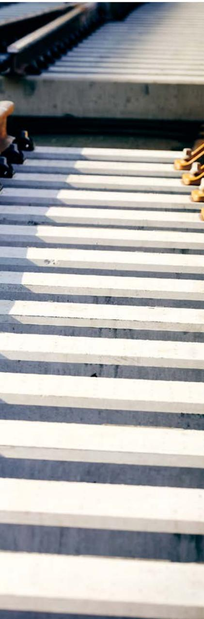
**Individuelle Maßarbeit:** Praktisch jede Weiche ist ein Einzelstück, das präzise auf den Einsatzort zugeschnitten ist. In der Produktionshalle in Zeltweg werden die Schienen zunächst auf den entsprechenden Weichenschwellen der TSF-A montiert.
