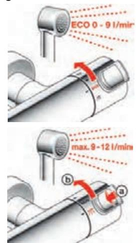
Eine leichte Drehung am Handgriff und die Wassermenge wird stufenlos reguliert. Mittels der Eco-Taste lässt sich zusätzlich komfortabel Wasser sparen. Wird der ECO-Bereich mit der Betätigung des Stoppknopfes verlassen, fließt die volle Wassermenge.
