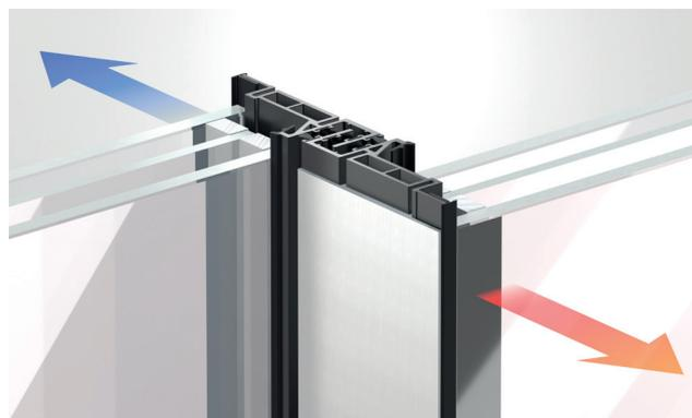
Isometrische Ansicht des spurversetzten Flügelstoßes
