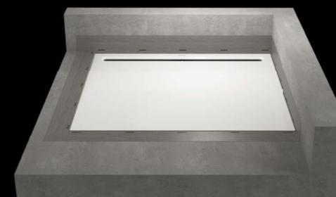
3 Nach dem Auflegen des NEXSYS-Systems wird die Duschrinne mit dem Ablauf verbunden. Im Anschluss werden die vormontierten Abdichtbänder in die Verbundabdichtung eingebracht und die Fliesenarbeiten können abgeschlossen werden.
