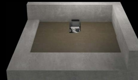
2 Dann erfolgt der Höhenausgleich durch Herstellung eines Estrichsockels oder – ganz ohne Trocknungszeiten – durch Unterbauelemente aus Hartschaum. Zur Bestimmung der richtigen Höhe finden Sie Hinweise in der Montageanleitung oder nutzen Sie die interaktive Onlineplanungshilfe.
