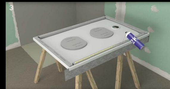
3 • Vormontierten Wannenträger extraflach mit 2K-Kleber, Silikon oder druckfreiem Montageschaum versehen
