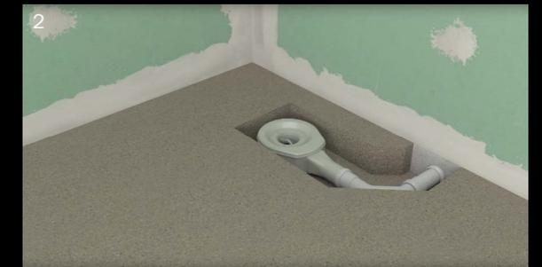
2 • Bodenaussparung herstellen (Estrich, Holzböden) und Ablaufgarnitur anschließen
