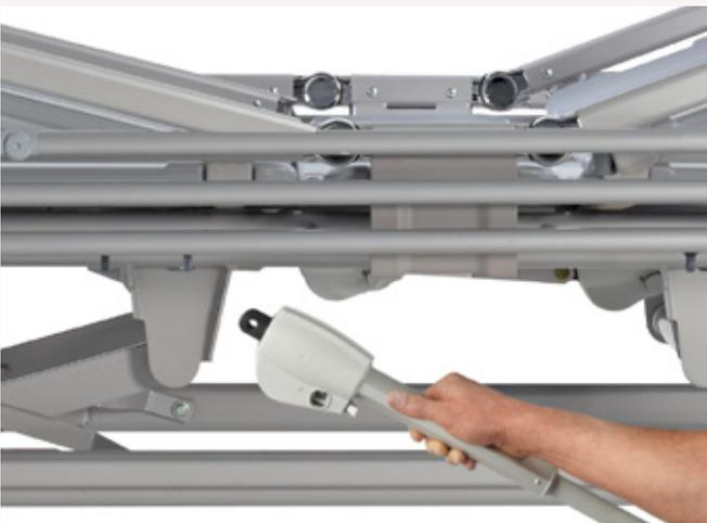
Gute Zugänglichkeit und „Plug-and-Play“-Komponenten ermöglichen das Konzept des „Boxenstopp-Service“. Teile wie Stellantrieb, Steuerkasten oder Batterie können in wenigen Minuten von nur einer einzelnen geschulten Person vor Ort ausgetauscht werden.
