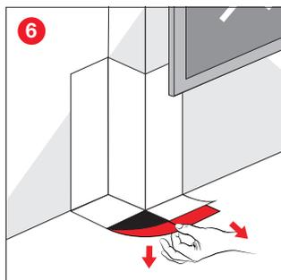
6 Bodenliegende Schutzfolien entfernen.
