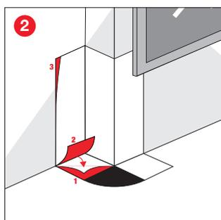
2 Schneiden Sie das Material am Winkel von 1 und 2 auseinander. Schutzfolie der Reihenfolge nach entfernen und fest andrücken.
