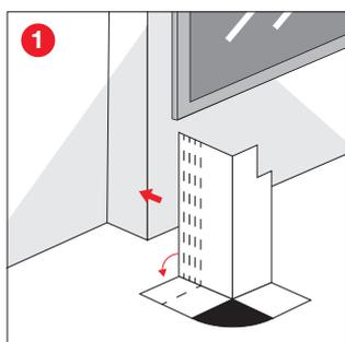
1 Manschette platzieren. Die gestrichelten Linien zeigen die Schutzfolienstreifen. In dem Bereich wird das Material umgeknickt.
