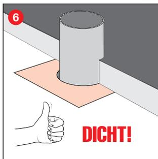
5 Die Manschette kann nun mit Dämmung und der wasserdichte Ebene überbaut werden.
