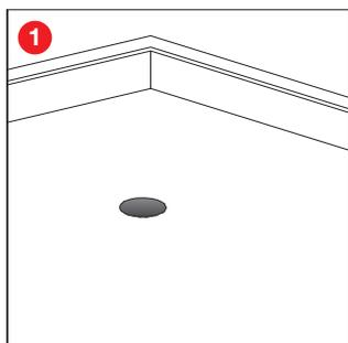
1 Bei Bitumenschweißbahnen ist die Besandung und/ oder Schutzfolie zu entfernen, durch z.B. Hitze.
