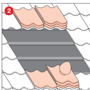
Lüftungspfanne und umliegende Ziegel entfernen.
