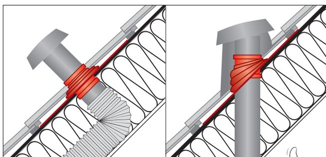
Gewerkeübergreifenden Anschluss von unten herstellen.
