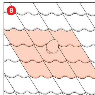
Lüftungspfanne und umliegende Ziegel wieder einsetzen.
