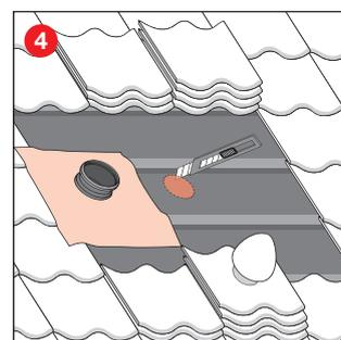
Loch in die Unterspannbahn schneiden.
