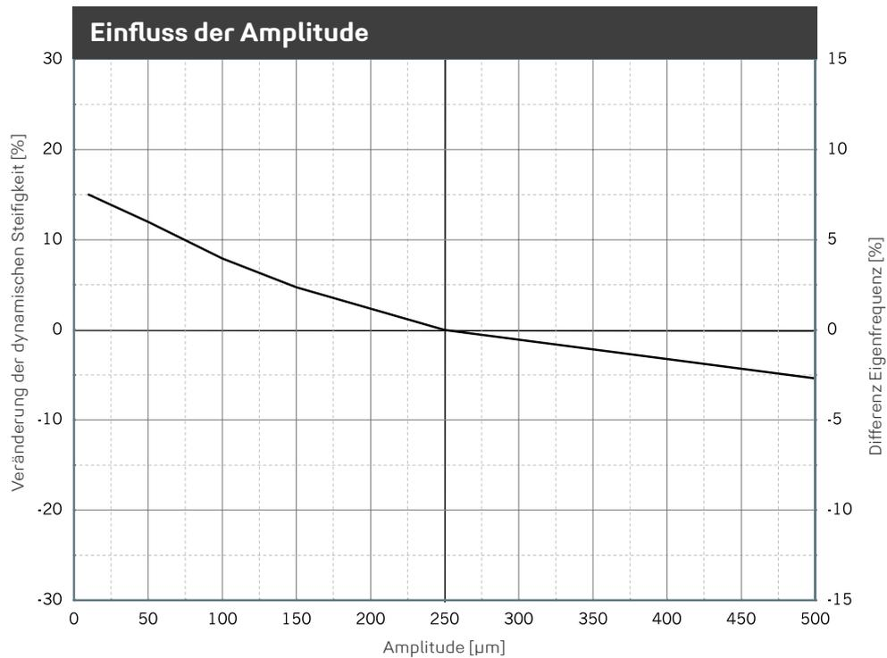
Veränderung der Steifigkeit aufgrund geänderter Amplitude. Mittelwert für 5 Hz, 10 Hz und 40 Hz Anregung. Sinusförmige Anregung bei konstanter Mittellast von 0,011 N/mm<sup>2</sup>, Probenabmessung 300 x 300 x 51 mm. Eigenfrequenz für einen eindimensionalen Feder-Masse-Schwinger auf starrem Untergrund.
