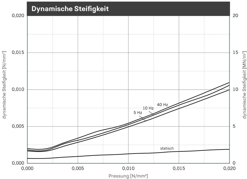
Verlauf der dynamischen Steifigkeit bei sinusförmiger Anregung um eine konstante Mittellast, Wegamplitude  $\pm 0,25$  mm. Probenabmessung 300 mm x 300 mm x 34 mm; Statische Steifigkeit als Tangentenmodul aus der Federkennlinie. Messung in Anlehnung an DIN 53513.
