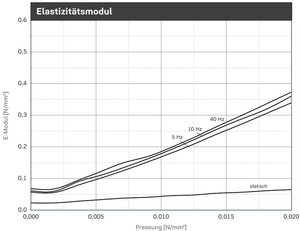
Verlauf des dynamischen E-Moduls bei sinusförmiger Anregung um eine konstante Mittellast, Wegamplitude  $\pm 0,25$  mm. Probenabmessung 300 mm x 300 mm x 34 mm; Statischer E-Modul als Tangentenmodul aus der Federkennlinie. Messung in Anlehnung an DIN 53513.
