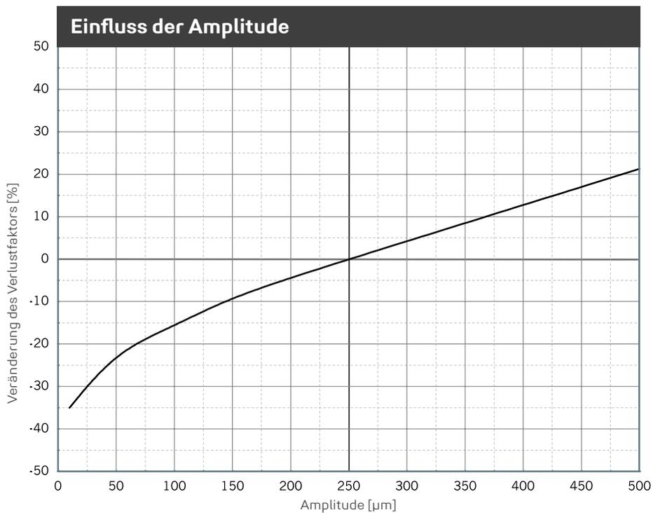
Veränderung des Verlustfaktors aufgrund geänderter Amplitude. Sinusförmige Anregung bei konstanter Mittellast von 0,011 N/mm<sup>2</sup>, Probenabmessung 300 x 300 x 51 mm.
