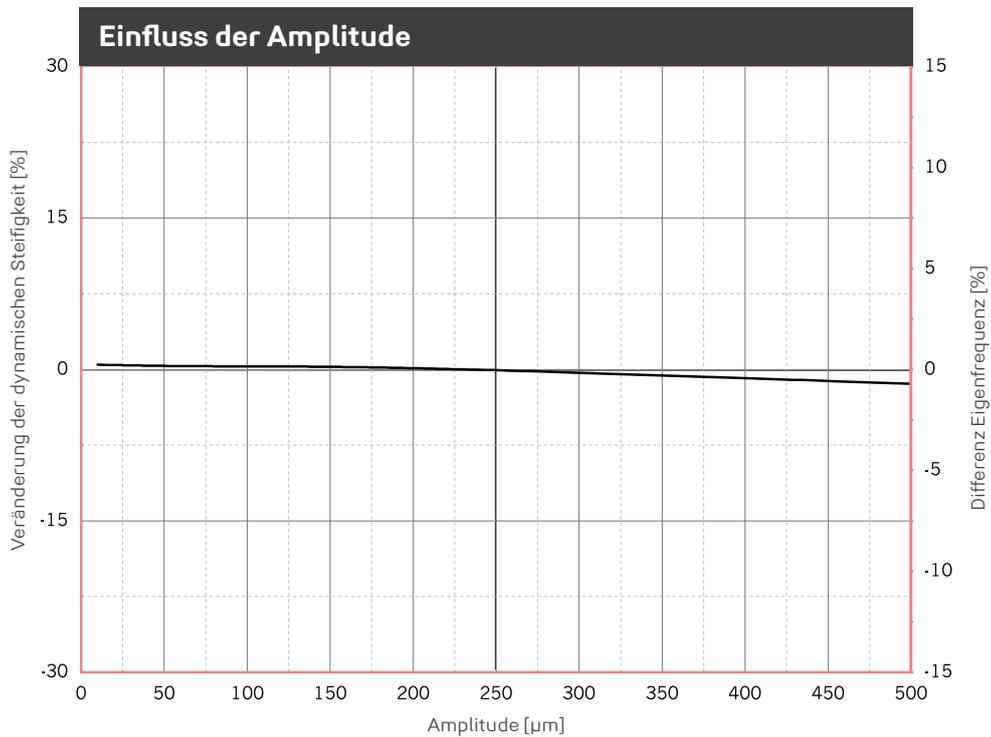
Veränderung der Steifigkeit aufgrund geänderter Anregeamplitude. Mittelwert für 5 Hz, 10 Hz und 40 Hz Anregung. Sinusförmige Anregung bei konstanter Mittellast von 0,300 N/mm<sup>2</sup>, Probenabmessung 300 x 300 x 25 mm. Eigenfrequenz für einen eindimensionalen Feder-Masse-Schwinger auf starrem Untergrund.
