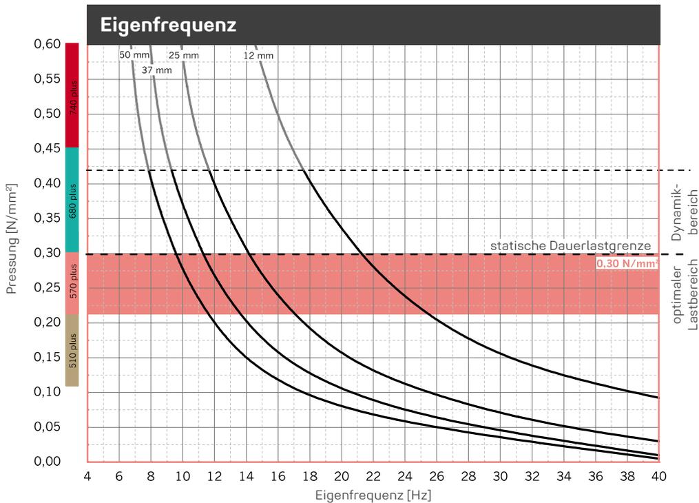
Eigenfrequenzverläufe für einen eindimensionalen Feder-Masse-Schwinger unter Berücksichtigung der dynamischen Steifigkeit von **REGUFOAM vibration 570plus** auf starrem Untergrund. Probenabmessung 300 mm x 300 mm.
