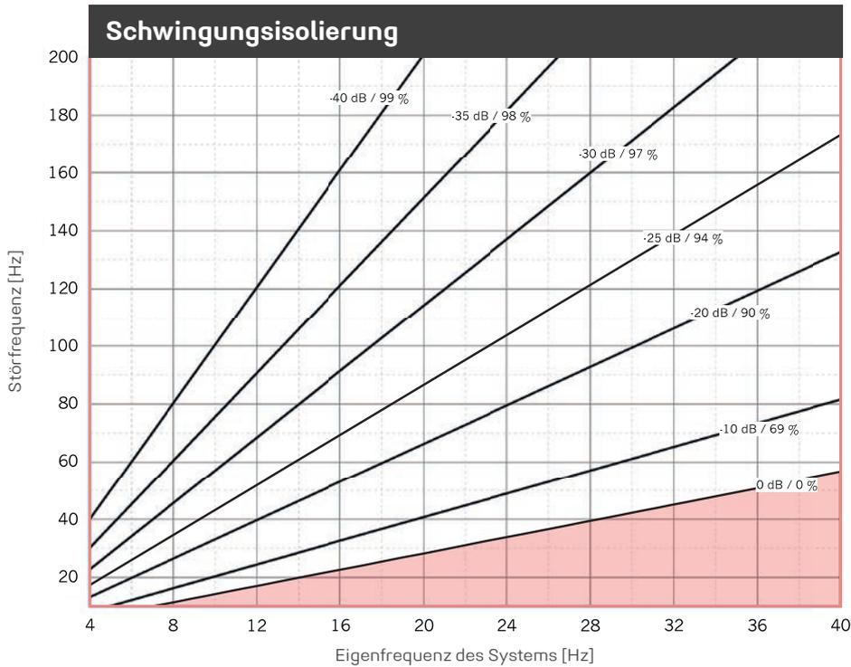
Dargestellt ist die Isolierung für einen Ein-Massen-Schwinger auf starrem Untergrund mit **REGUFOAM vibration 570plus**. Parameter: Kraftübertragungsmaß in dB, Isolierwirkungsgrad in %.
