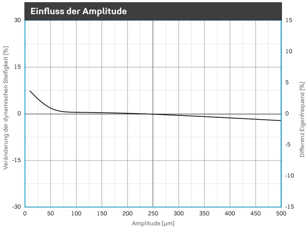
Veränderung der Steifigkeit aufgrund geänderter Anregeamplitude. Mittelwert für 5 Hz, 10 Hz und 40 Hz Anregung. Sinusförmige Anregung bei konstanter Mittellast von 0,042 N/mm<sup>2</sup>, Probenabmessung 300 x 300 x 25 mm. Eigenfrequenz für einen eindimensionalen Feder-Masse-Schwinger auf starrem Untergrund.
