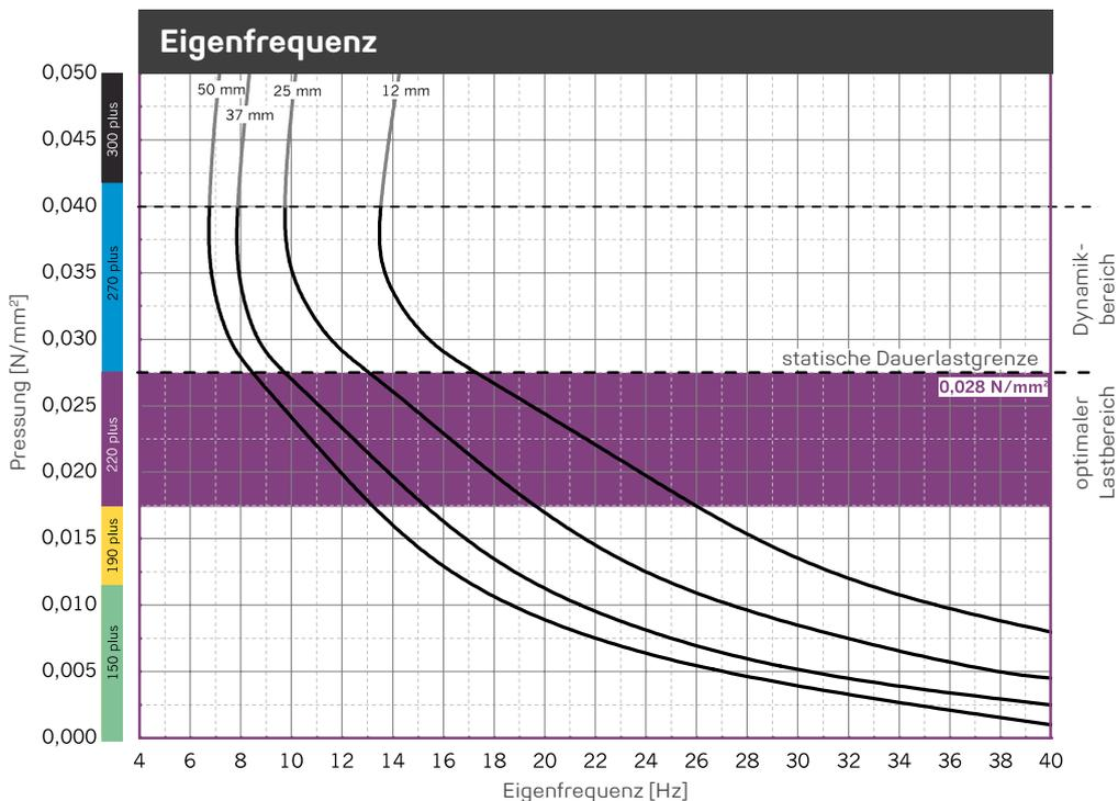
Eigenfrequenzverläufe für einen eindimensionalen Feder-Masse-Schwinger unter Berücksichtigung der dynamischen Steifigkeit von **REGUFOAM vibration 220plus** auf starrem Untergrund. Probenabmessung 300 mm x 300 mm.
