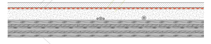
Massivholzdecke, 5-lagig, d= 160mm, aus Brettsperrholz ED-BSP, Längslagen d= 40mm, Querlagen d= 20mm CLT-Massivholzdecke
