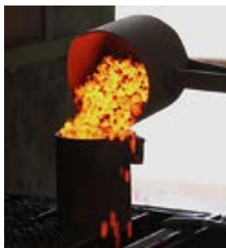
Nah dran: die gerade gebrannten Liapor-Blähton-Kugeln.
