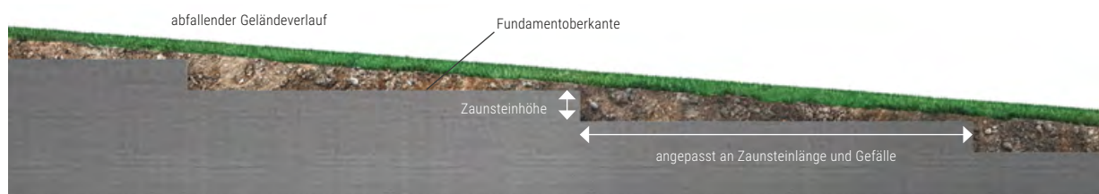
Abbildung 8: Abgestuftes Fundament bei einem Gefälle
