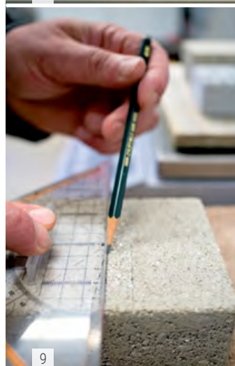
8 + 9 + 10 Bestimmung des Abriebwiderstands. Die Oberseite des Steins wird mit einem Schleifmittel unter genormten Bedingungen abgeschliffen. Die Abriebstelle angezeichnet und an drei Stellen gemessen.
