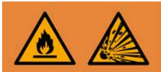
R-290 ist ein entflammbares und explosives Gas. Gehen Sie mit maximaler Vorsicht vor!
