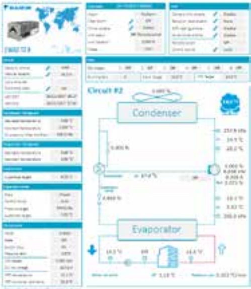
Kreislaufübersicht – Echtzeitdaten Für Instandhaltungskontrolle und Diagnose
