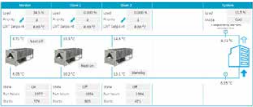
Anlagenübersicht, mit Echtzeitdaten Vollständiger Einblick in Anlagenbetrieb zur Inbetriebnahme und Optimierung
