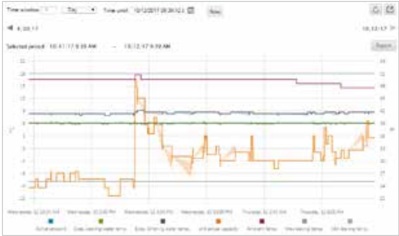
Verlaufsdaten: Parameter auswählen, Zeitraum auswählen, zoomen ... Vollständiger Einblick in Anlagenbetrieb für Diagnose und Optimierung
