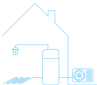
Modell F mit integriertem Edelstahl-Warmwasserspeicher
