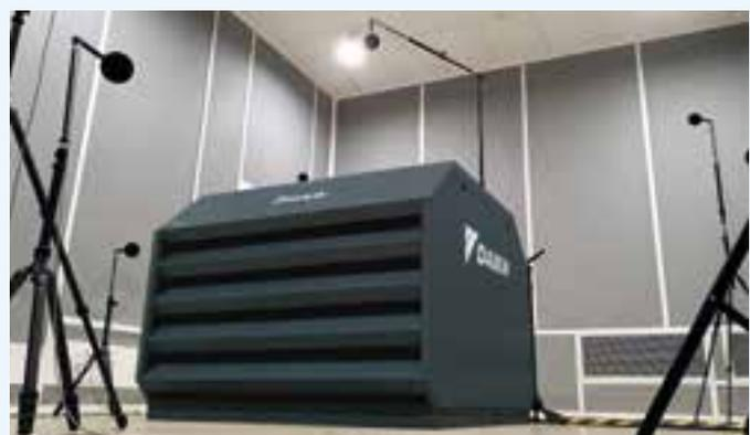
Messung der Schallleistungspegel in einer Akustikkammer
