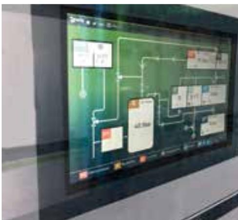
Günstigste Lösung für transkritisch und subkritisch betriebene CO<sub>2</sub>-Systeme mit Booster-Kreislauf, zudem Regelung von bis zu zwei Wärmerückgewinnungskreisen möglich
