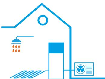
Modell F mit integriertem Edelstahl-Warmwasserspeicher
