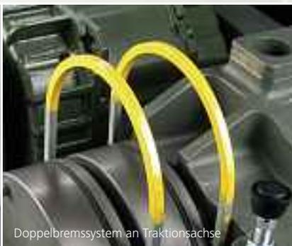
Doppelbremssystem an Traktionsachse
