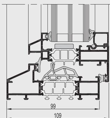
Das einzigartige Fenster- und Türsystem OS 38-SL von Reynaers wird in einer weiterentwickelten Version neu aufgelegt. Mit ultraschlanken Profilen und einer verbesserten Energieeffizienz sind SL 38 und SL 38-HI würdige Nachfolger. Durch die Kombination von hervorragenden Wärmedämmwerten, einem klaren Design und all den Vorzügen des Werkstoffs Aluminium erfüllt das System höchste architektonische Ansprüche.
