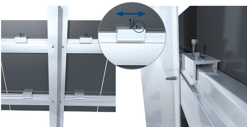
Nach dem Ausrichten der BEMO-BOND Fassadenplatten werden diese mittels selbstbohrender Festpunktschrauben in ihrer Lage gesichert. Idealerweise sitzt der Festpunkt mittig, damit die Längenausdehnung nach links und rechts stattfinden kann. Die Anordnung der Festpunkte sollte immer übereinander liegend stattfinden und innerhalb der Plattenreihen nicht versetzt werden.
