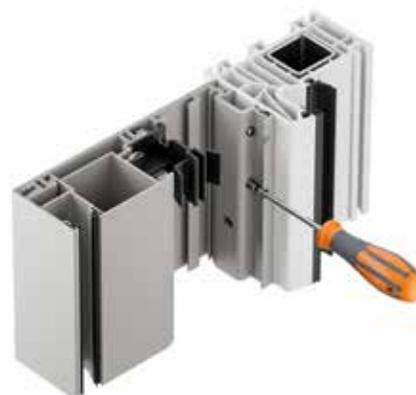
Bauseits kein Ausrichten seitlich mehr nötig. Führungsschienenabdeckung lösen, Elemente ansetzen und mittels Gewindestiften von der Seite befestigen.
