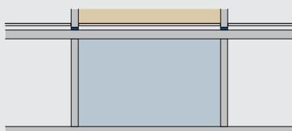
Aufdeckendämmung Tiefgarage / Keller
