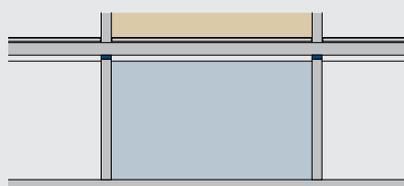
Unterdeckendämmung Tiefgarage / Keller
