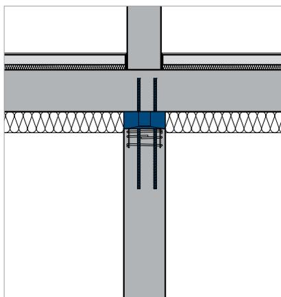
Anwendung am Stützenkopf für Unterdeckendämmung.
