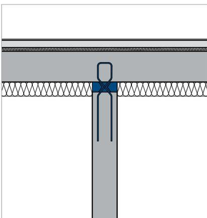
Anwendung am Wandkopf bei Unterdeckendämmung.
